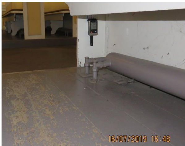
Abbildung 3: Beispiel Bachkirche Arnstadt Datenlogger im Gestühl 2. Bankreihe rechts
